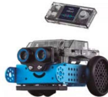
Diseñado para que reflejen aplicaciones del mundo real con tecnologías de vanguardia. Impulsado por CyberPi, un microcontrolador educativo con capacidades de conexión en red, sensores integrados y mucho más. Programación en Scratch y Python. Robots en 1: impulsado por CyberPi, microcontrolador. Con sensores, pantalla a color y comunicación Wi-Fi integrados.
