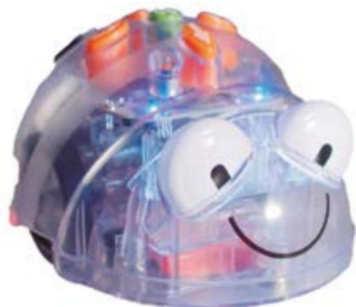
**BLUEBOT**® robot programable de dos maneras: mediante panel direccional integrado y por vía remota. Esto supone un extra de interés, dificultad y abstracción
