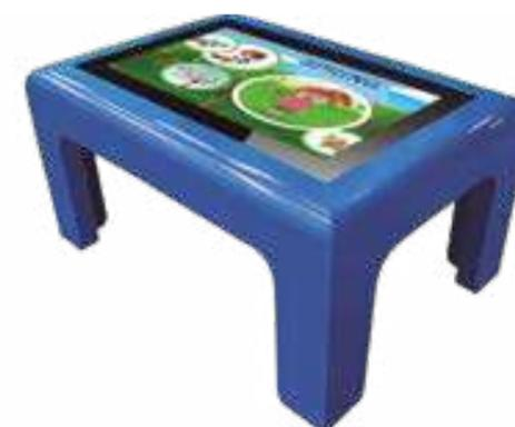
Mesa interactiva táctil capacitiva de 32" con sistema Android integrado. Dispone de una pantalla capacitiva multitáctil, así como altavoces integrados. Incorpora una versión de Android 11 completa. Superficie de cristal templado de 6mm a prueba de golpes. Disponible en azul.
