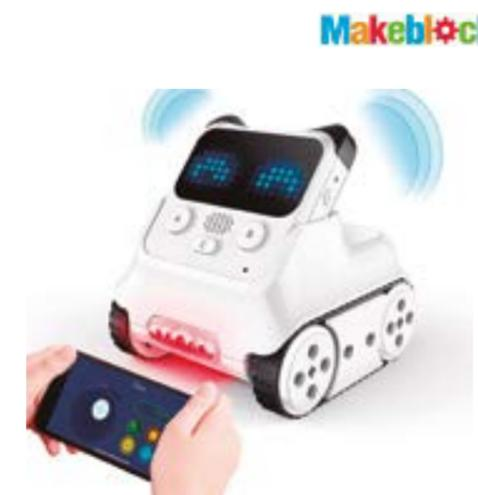
• El robot se conecta mediante: Bluetooth, cable USB y Wi-Fi
